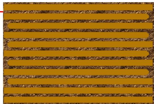
6. Die Lücken mit HL-Ausgleichsmasse trocken verfüllen.
